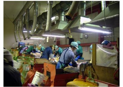
資源ごみが回収されてくる施設。缶類は内容物を確認した後、磁石を利用してアルミとスチールに分類、処理される。ペットボトルは細かく粉碎して水の中に投入。ラベルなど浮く素材と分離して処理。ビンは手作業で色別に仕分けられる。修理、リメイクされたものは抽選で希望者に販売される。
